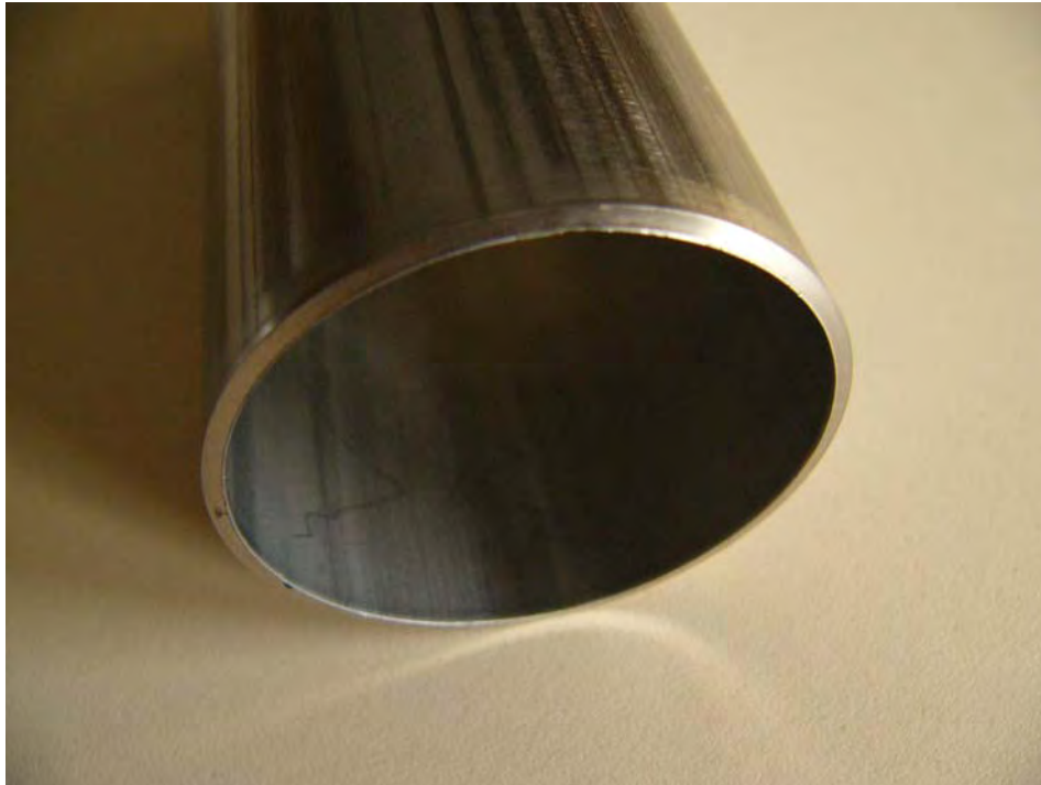
VA-Rohr 56x1,5 mm spanlos getrennt, „gerissen“ und „gebrochen“
