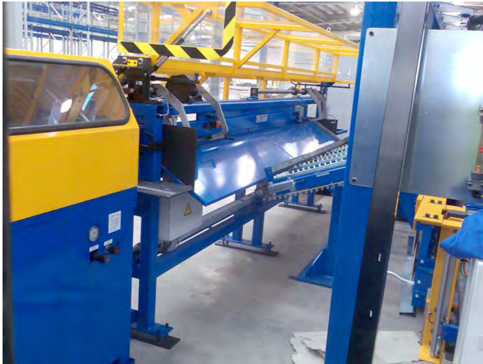
Rohrtrennautomat RTA 35 mit Sor- tiereinrichtung der Rohrabschnitte
