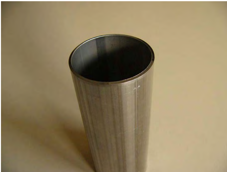
Spanlos getrenntes Rohr, „gerissen“
