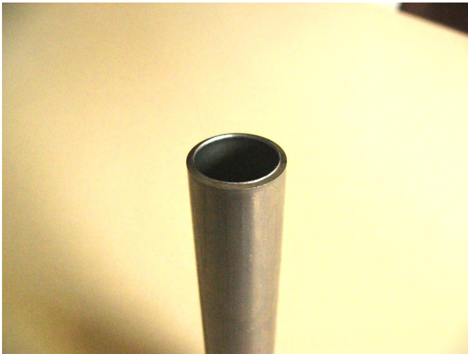
Rohr spanlos getrennt und „gerissen“.
