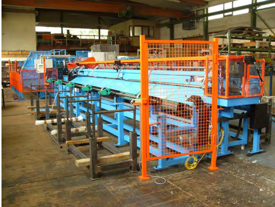
Rohrtrennautomat RTA 75 mit 4-fach- Bündellader und Sortiereinrichtung für lange Rohrab- schnitte bis 5,7 m Länge
