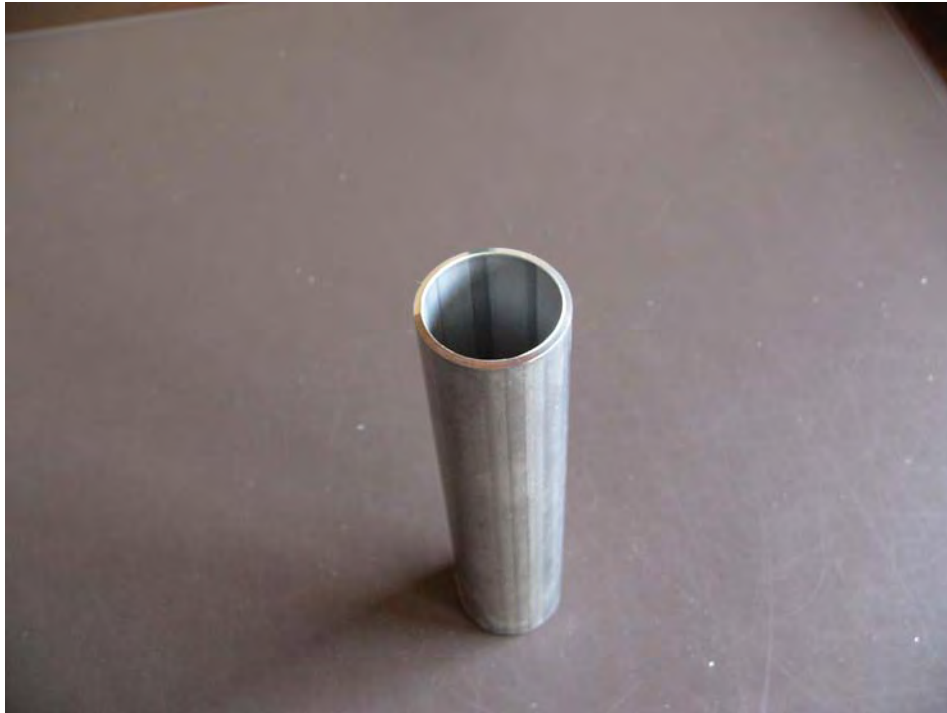
VA-Rohr spanlos getrennt und „gerissen“.
