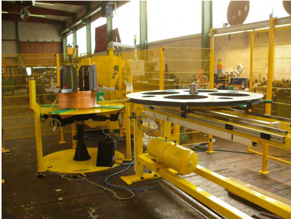
Coil-Rohr-Zuführung mit Haspel und Ausgleichsrolle
