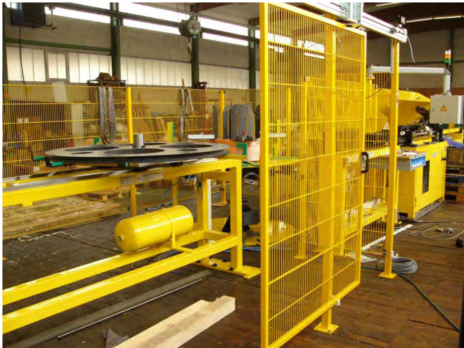
Rohrcoil-Zuführung zum Rohrtrennautomaten RTA 35 mit Haspel und Ausgleichsrolle
