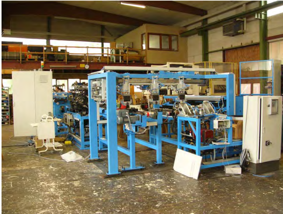
Rohrtrennautomat mit Greifersystem für verkettete Arbeits- folgen
