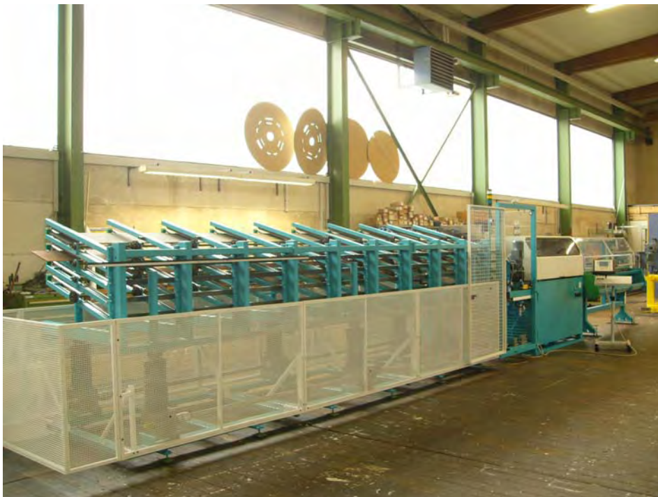
Rohrtrennautomat RTA 35 für kleine Rohrdurchmesser 4 bis 12 mm
